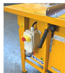
Regolazione altezza di taglio. Cutting height adjustment.
